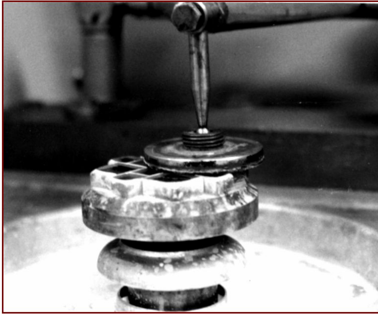
図2 レンズ研磨機による結晶研磨 (中央部は結晶、外側はブロック状ガラスダミイ)
