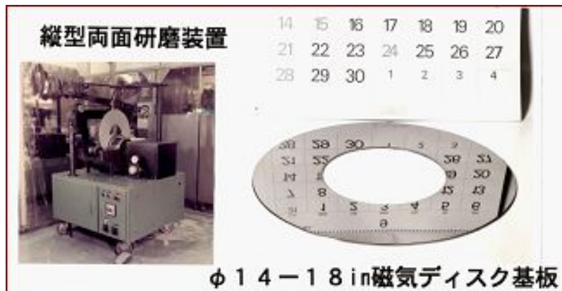
図5.2 大口径磁気ディスクと修正輪形研磨機の応用として 試作した縦型両面研磨機
